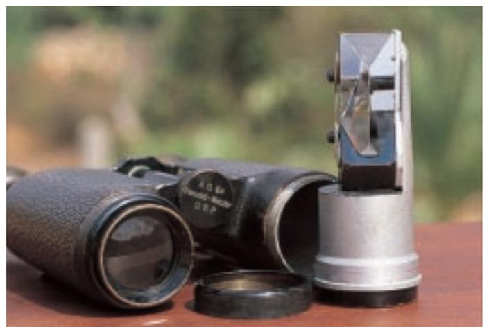
Abb. 2 Eines der ersten Ferngläser mit Dachprismen, eine Innovation von Hensoldt. Rechts das Objektivgehäuse mit dem schlanken Dachprisma.
