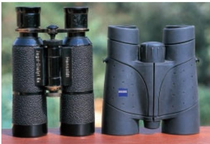
Das Hensoldt Jagd-Dialyt 6x36, links, stammt aus den 20er Jahren, zu einer Zeit als man die Geometrische Lichtstärke als Maß für die Dämmerungsleistung benutzte. Die Geometrische Lichtstärke belief sich auf 36. Rechts das Zeiss Victory 10x40 mit der Dämmerungszahl 20. Die Dämmerungsleistung ist aufgrund des fortschrittlichen optischen Systems um rund fünf Prozent höher als sehr gute 8x42 oder 10x42 Gläser
