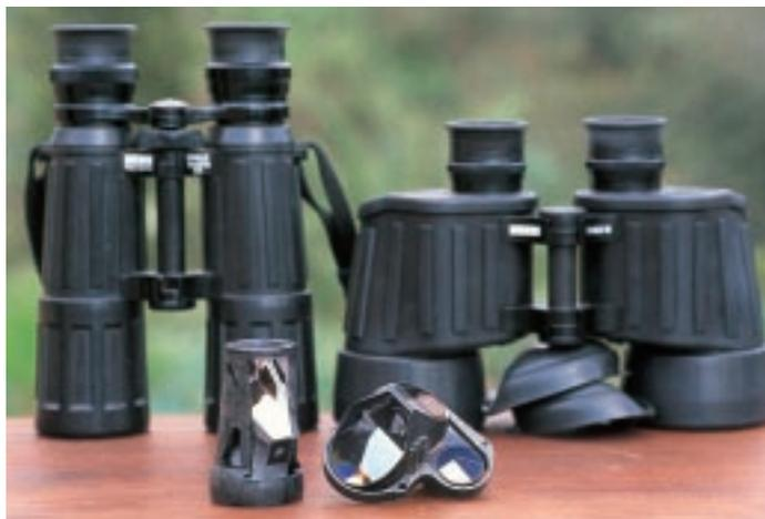
Abb. 3 Deutlich ist der Unterschied in der Bauform eines 7x42 Dachprismenglases (links) und eines 7x50 Modells mit Porro-Prismen zu erkennen. Ferngläser mit Porro-Prismen, wie das klassische Zeiss Marineglas, sind auch heute noch für den Einsatz in der Nautik sehr beliebt.
