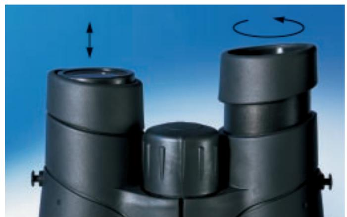
Abb. 12 Bei der Benutzung des Fernglases mit Brille werden die Brillenträger-Okulare eingeschoben und gewährleisten so den richtigen Augenabstand. Wird das Glas ohne Brille benutzt, wird bei diesem Modell das Okular herausgezogen und dann durch eine Drehbewegung arretiert.
